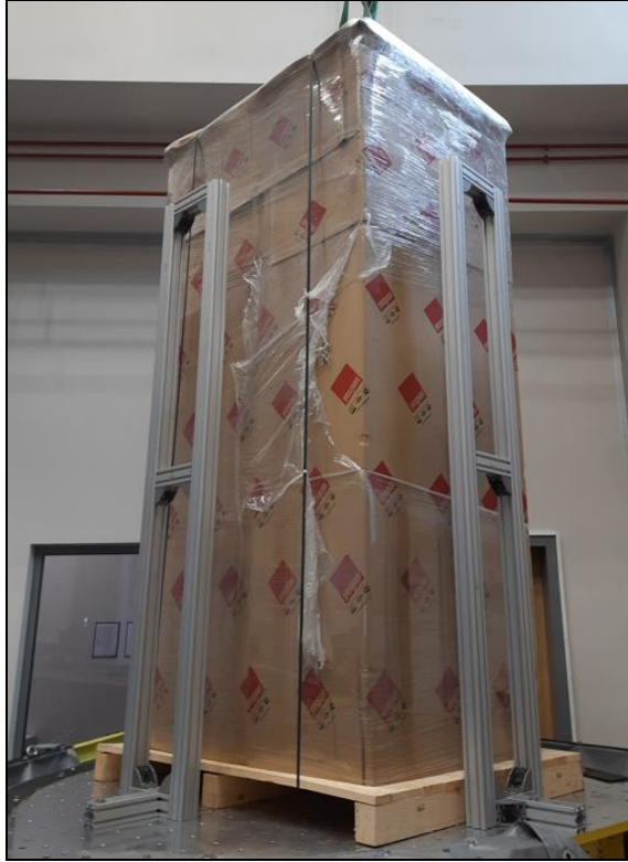
Şekil 1. 1 palet üzerine sabitlenmiş YESPAN Dış Mekan Dikili Tip Modüler Muhafaza (Model Numarası: H Serisi, Seri Numarası: YD22246)
